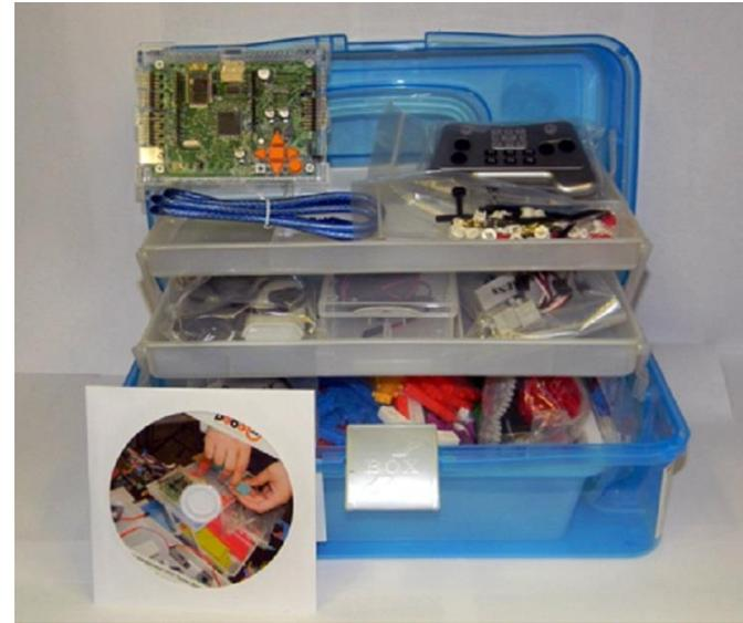
Элементы конструктора выполнены из прочного материала, их крепкий корпус можно применить в любом робототехническом проекте. Основные датчики робототехнического конструктора позволяют смоделировать производственный процесс, разрабатывать прообразы автоматизированных производственных линий и площадок, проводить исследовательские работы, осуществлять движение собранных моделей по сложным траекториям, реальные технологии, используемые в технической аппаратуре и в производственных процессах.
